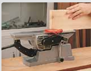
Stojak umożliwiający użycie urządzenia w pozycji stacjonarnej.
