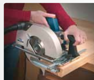
Wykonuje cięcia do 70 mm.
