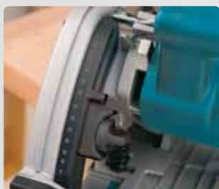
Praktyczny oraz precyzyjny system dostosowania głębokości w zakresie od 0 do 55 mm.
