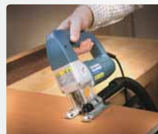
Kąt cięcia od 0° to 45°.
