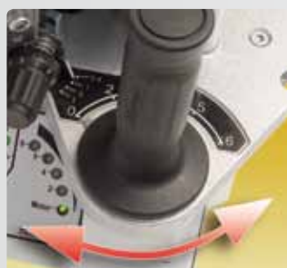
Kontrola prędkości sterowana mikroprocesorem.
