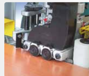
Jednoczesne frezowanie z góry i od spodu, zaokrąglone lub pod kątem 10 stopni.
