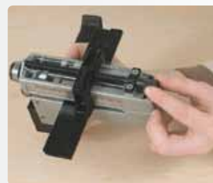
Mikrometryczne pokrętko do regulacji szerokości cięcia.
