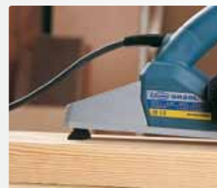
Stoper, zapobiegający uszkodzeniu powierzchni podczas spoczynku/postoju.
