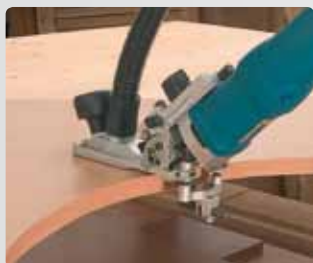
Kopiarka z łożyskiem kulkowym. Idealne prowadzenie na zakrzywionych powierzchniach.
