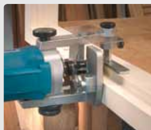
Wykonywanie felcu za pomocą frezu numer 1240046 (użycie prowadnicy 1250041 lub 1850042)
