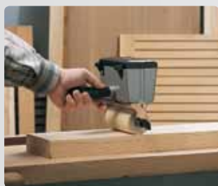
Równomierne nakładanie kleju na większe powierzchnie.
