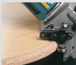
Zaokrąglenie lub cięcie krawędzi po promieniu R=5,10 lub 15 przy użyciu kopiału oraz dodatkowego ostrza nr. 9841005.
