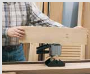
Nakładanie kleju za pomocą wałka górnego.
