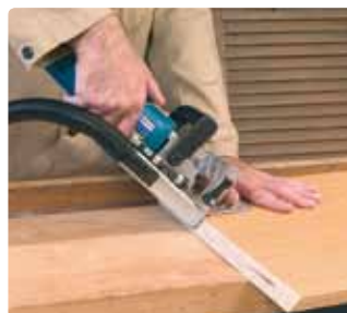
Spojenia pod kątem 45 stopni.
