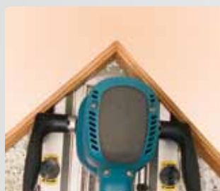
Dzięki możliwości demontażu frontowej części głowicy możliwe jest wykonanie cięć w narożnikach podczas przycinania listew.
