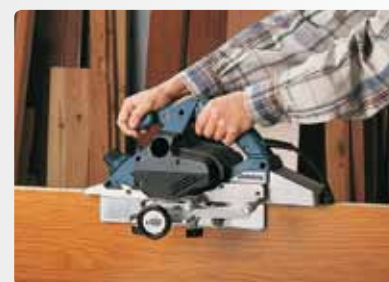
Mikrometryczna prowadnica umożliwiająca precyzyjne frezowanie krawędzi.
