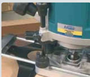
Błyskawiczne ustawienie sześciu pozycji głębokości.
