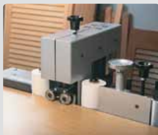
Obcinanie okleiny na równo z płytą po obu stronach panelu jednocześnie.
