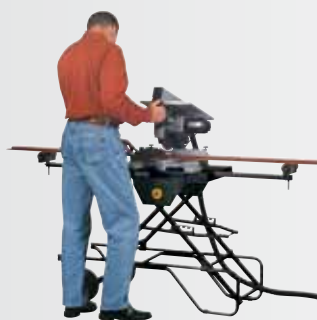
Przedłużenie 5845325, zamocowane po dowolnej stronie stołika, umożliwia komfortową pracę z użyciem długich elementów. Jest ono wyposażone w ruchomy wałek, ułatwiający swobodny ruch obrabianego elementu.
