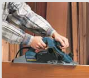
Regulacja głębokości strugania z automatyką skalowania co 0,2 mm.
