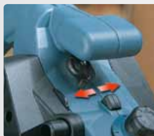
Przełącznik selektora wydmuchu odpadów (prawo-lewo).
