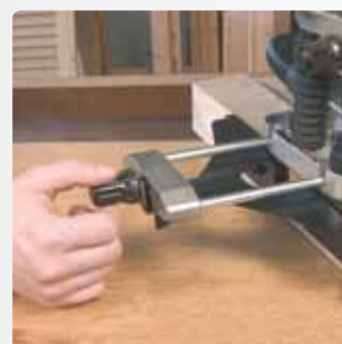
Przymiar boczny z mikrometryczną regulacją.
