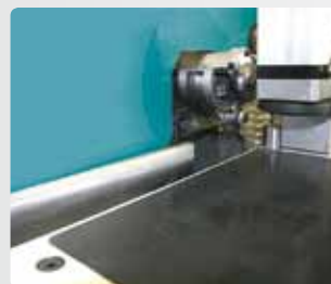
Listwa prowadząca od strony krawędzi z obrzeżem, które ma być opracowane.
