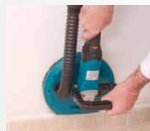
Demontaż części głowicy szlifującej ułatwia szlifowanie trudno dostępnych powierzchni.
