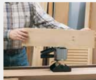
Nakładanie kleju za pomocą wałka górnego.
