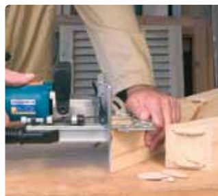
Spojenia ościeżnic z lamelką 6.
