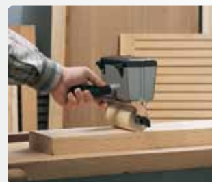
Równomierne nakładanie kleju na większe powierzchnie.
