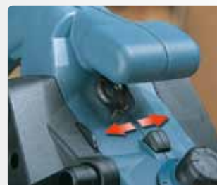
Dźwignia selektora wydmuchu odpadków (pravo-lewo).
