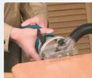
Okrągła głowica dołączona do zestawu. Bardzo praktyczna do frezowania krawędzi.
