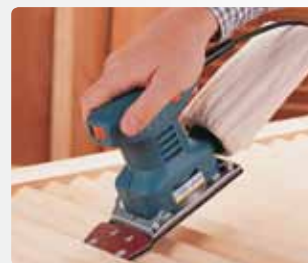
Szlifowanie trudno dostępnych powierzchni np. żaluzji itp.
