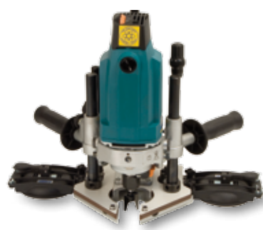
6045756 Zestaw przyssawek Pozwala zamocować urządzenie do powierzchni roboczej przy frezowaniu otworów.
