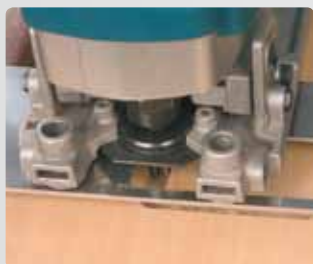
Pierścień prowadzący daje funkcje routera.
